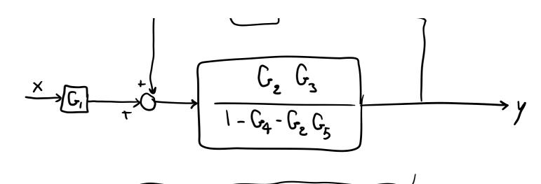
$$T = \frac{y}{x} = \frac{G_1 G_2 G_3}{1 - G_4 - G_2 G_3 - G_2 G_3 G_4}$$
