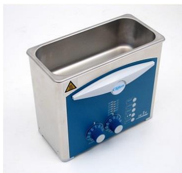
شکل ۱۹-۶- دستگاه‌های مورد استفاده برای فرایندهای سونوشیمیایی؛ سمت راست: حمام فراصوت و سمت چپ: نوع میله‌ای.
