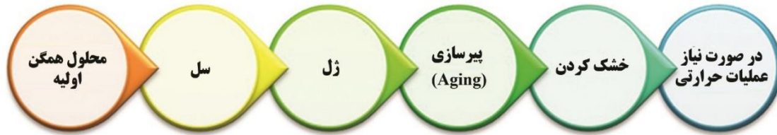
شکل ۱۶-۵- مراحل مختلف سل ژل و جایگاه فرآیند Aging در آن
